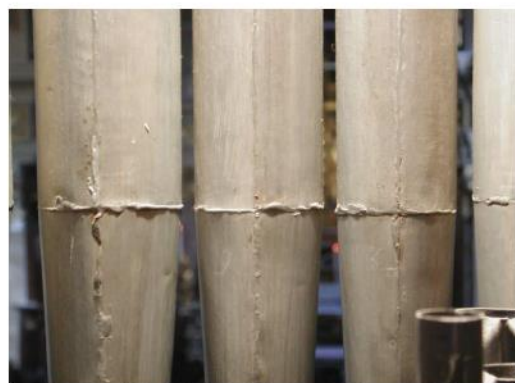
6 Particolare della saldatura delle canne di facciata dell'organo di Primolo.
