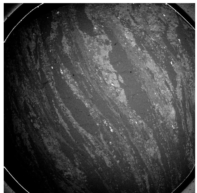
Figura 6 - Dorato Valmalenco “Classico”, immagine SEM in elettroni retrodiffusi, modalità fisheye.
