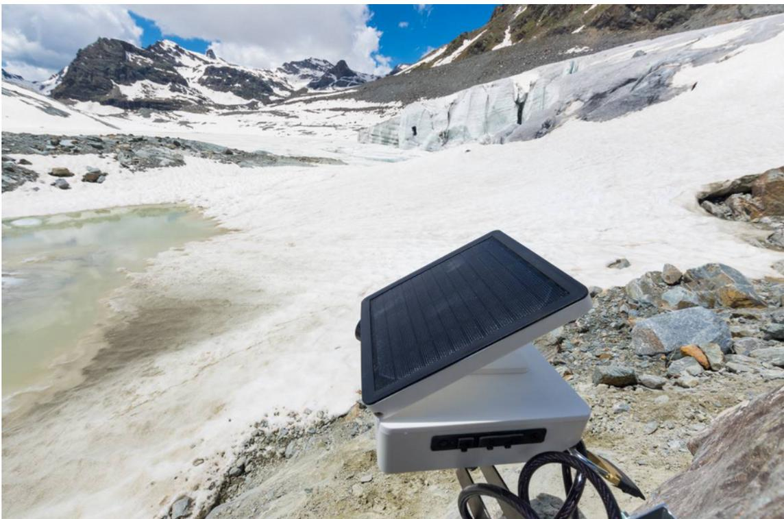
Fig. 3. Fotocamera ENALPS tikee (Fellaria 1 – lago) installata
